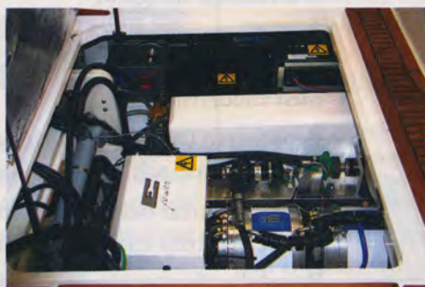
Nu kommer de stora el-motorerna till fritidsbåtarna. Här Nimbus prototyp, som driver deras 27 fotare i ljuslösa 27 knop.
