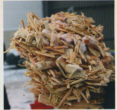
Här en klump bränsle till fjärrvärmepannan. Träflis som kommer från trädgårds- och skogsavfall.
